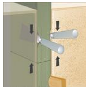
Bild 2: Stumpfstoß im Massivbau
