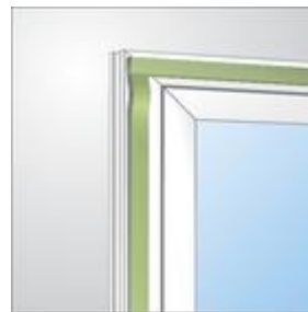
Bild 1: Eckauslegung bei der Fenstermontage
